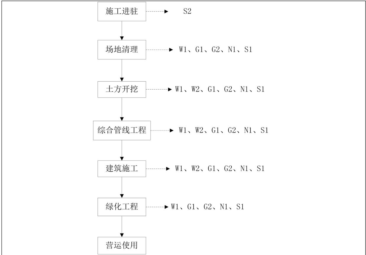
图 4-1 施工期工艺流程及产污节点图
